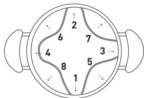
パッキングをセットしたら、なべに1カップ程度の水を入れて、ふたを完全に閉めて火にかけます。しばらく圧力をかけると、確実にパッキングがセットされます。
