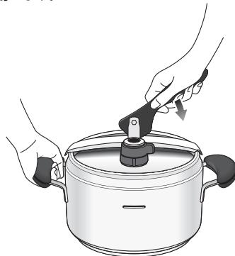
本製品はハンドルが完全に押し倒されたときにのみ、ふたとなべ本体が完全に密着し、加圧調理が可能になるように設計されています。ハンドルが完全に押し倒され、動かない状態になっていることを確認してください。
