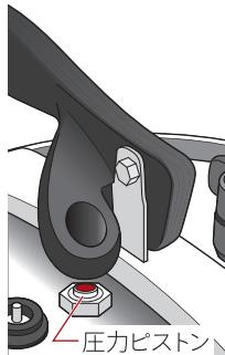
圧力が完全に抜けて、圧力ピストンが下がっている状態
